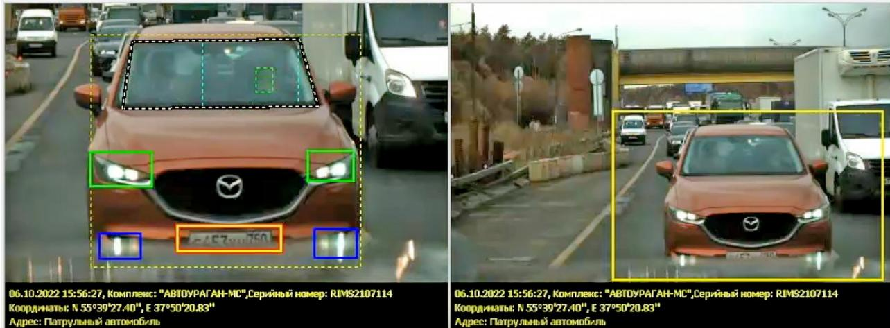
**В программу комплекса встроен нейросетевой анализ видеоизображения. Нейросеть определяет особые участки в видеокадре с ТС и автоматически анализирует эти зоны по определённому параметру. В результате, в режиме реального времени система выявляет следующие зоны на ТС:**
