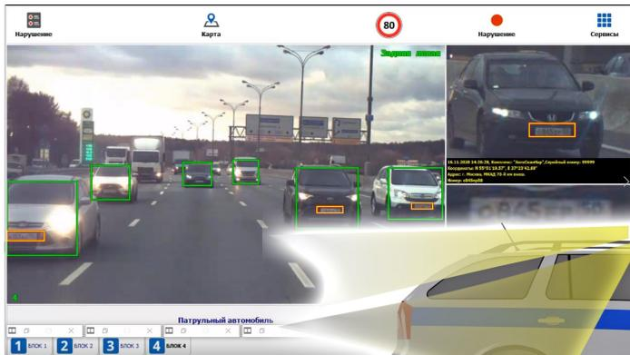
Патрульный автомобиль, оборудованный комплексом, проводит автоматическую фото-видеофиксацию окружающих ТС. При этом АПК осуществляет распознавание ГРЗ и определяет скорость движущихся ТС (до 350 км/ч).
